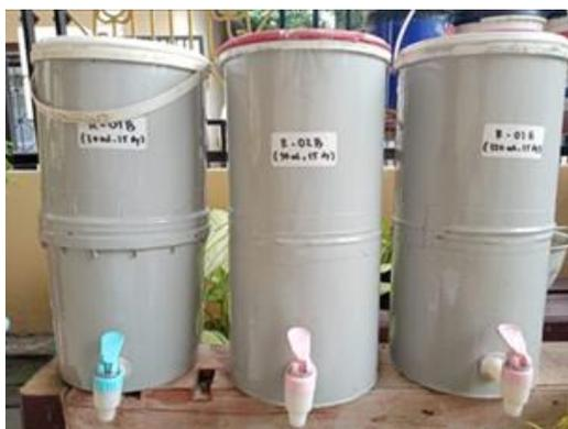
Gambar 7. Alat Komposer Sederhana Pembuat POC
