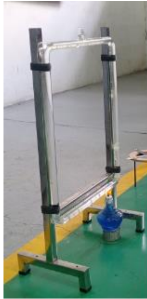
Gambar 3. Peralatan Praktik Penghantar Panas pada Benda Cair
