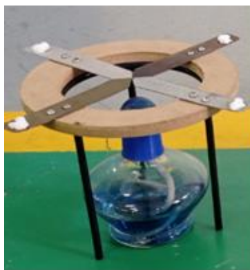
Gambar 2. Peralatan Praktik Penghantar Panas pada Benda Padat
