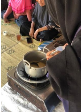
Gambar 2. Proses pencampuran stearin dengan minyak jelantah
