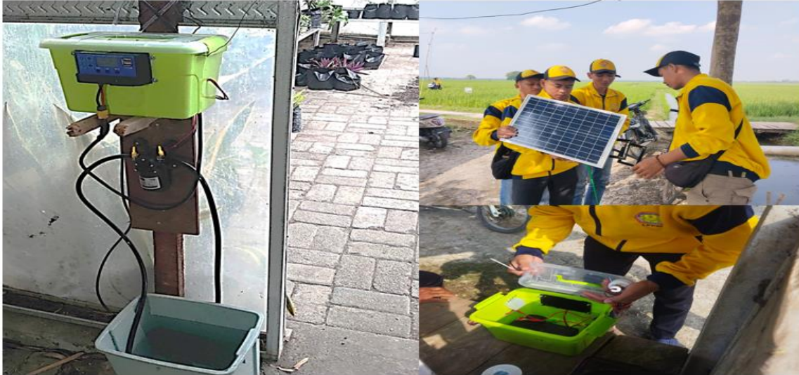
Gambar 3. Proses pembuatan dan perakitannya alat penyiram tanaman otomatis dengan tenaga surya (solar panel).
