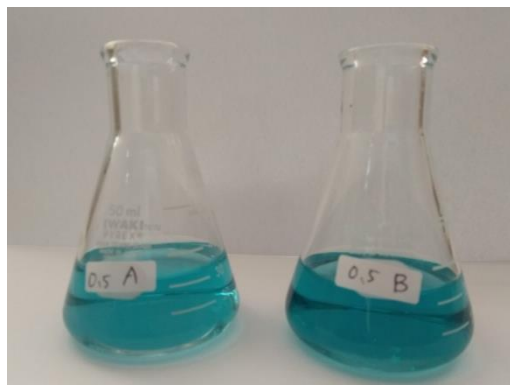
Gambar 1. Standar N-NH 3 Setelah Penambahan Reagen A dan Reagen B
