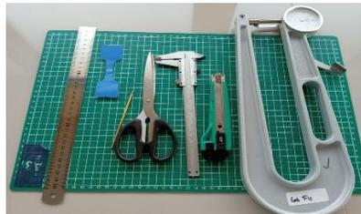
Gambar 1. Peralatan untuk membuat sampel
