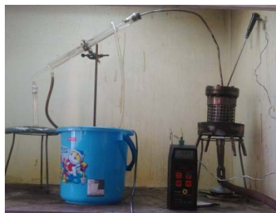
Gambar 4. Perengkahan tallow dengan reaktor sistem terbuka
