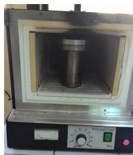
Gambar 3. Perengkahan tallow sistem tertutup
