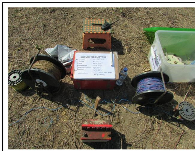
**Gambar 2. Alat Geolistrik dan Peralatan Pendukung lainnya**
