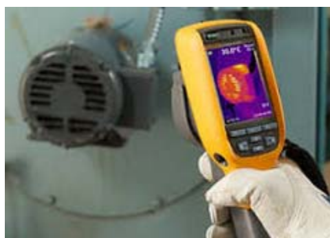
Gambar 15. Pengukuran Suhu dengan metoda Thermal Imaging menggunakan Fluke Infrared Camera
