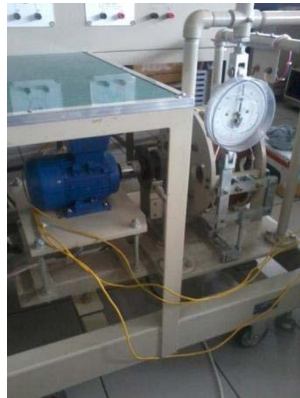
Gambar 17. Modul uji pembebanan motor di Laboratorium Pengemudian Elektrik di kampus PENS Surabaya
