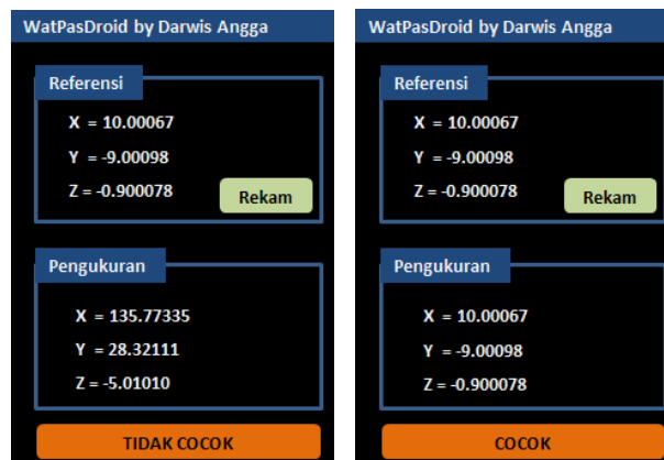
Gambar 12. Mengukur nilai kerataan bidang uji. Belum cocok (kiri) Sudah cocok (kanan)
