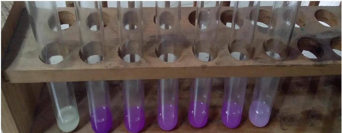
**Gambar 3.** Tabung Reaksi yang Berisi Sampel Tahu Kode A, B, C, D, E, F dan G Yang Sudah Ditetesi Test Kit Formalin
