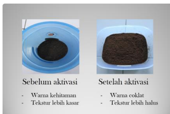
Gambar 2. Perbedaan Adsorben Sebelum Aktivasi dan Setelah Aktivasi dengan Akuades
