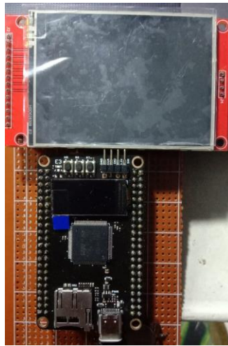
Gambar 2.1. Tampilan LCD Modul STM32H750 dengan platform OpenMV yang dimodifikasi agar tampilannya lebih besar
