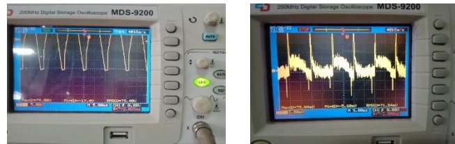
Gambar 9. Bentuk gelombang keluaran tidak normal
