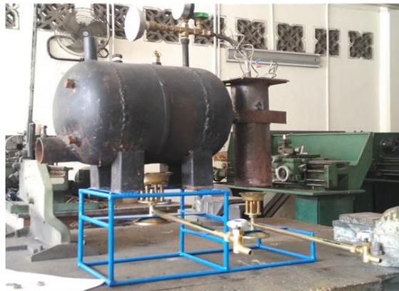
Gambar 1. Gambar mini boiler dengan tabung reaktor
