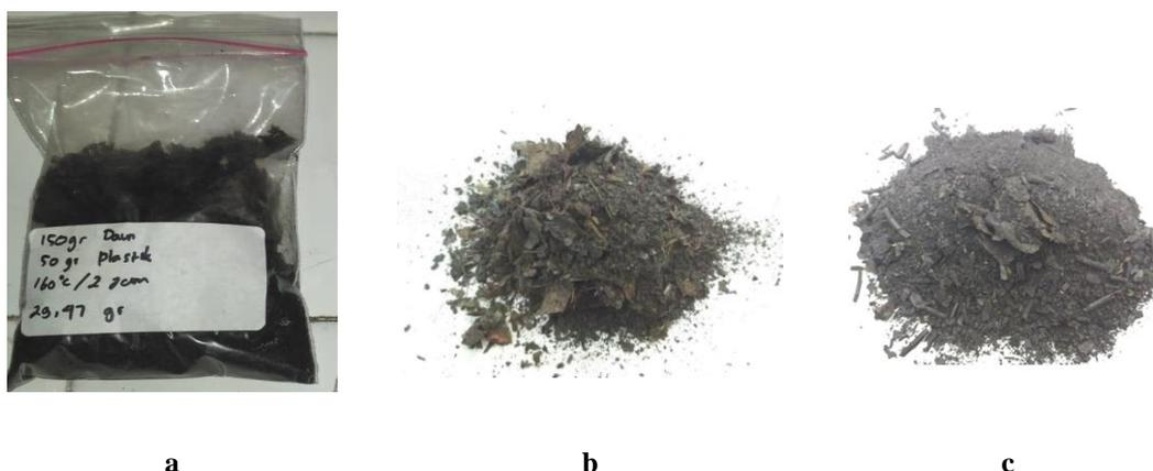
**Gambar 3.** Hasil pengolahan sampel dengan proses hidrotermal (a) 1:3, (b) 1:1, (c) 3:1
