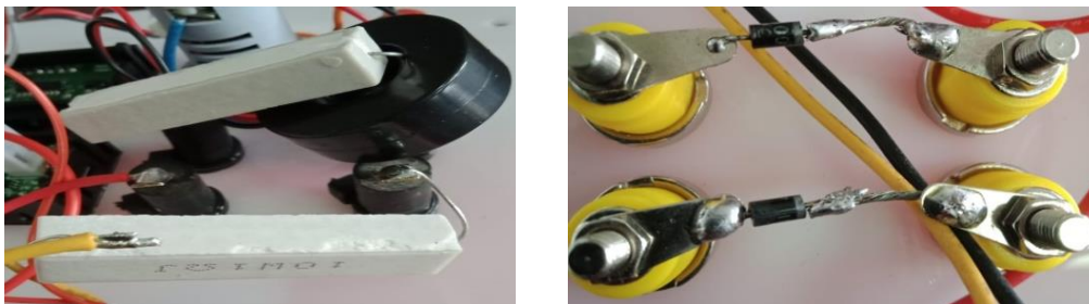
Gambar 1. Resistor kapur 1 Ohm 10 Watt dan Diode IN4007
