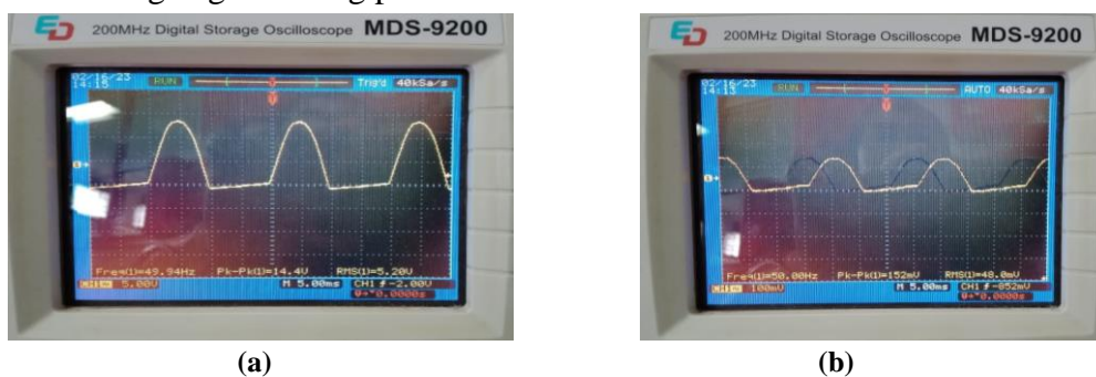
Gambar 6. (a) Bentuk gelombang tegangan listrik keluaran penyearah setengah gelombang dan (b) Bentuk gelombang arus listrik keluaran penyearah setengah gelombang pada beban 100% x 1847 Ohm.
