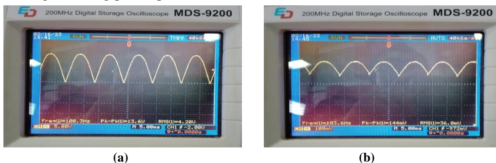
Gambar 11. (a) Bentuk gelombang tegangan listrik keluaran penyearah gelombang penuh dan (b) Bentuk gelombang arus listrik keluaran penyearah gelombang penuh pada beban 50\% \times 1847 \text{ Ohm} .
