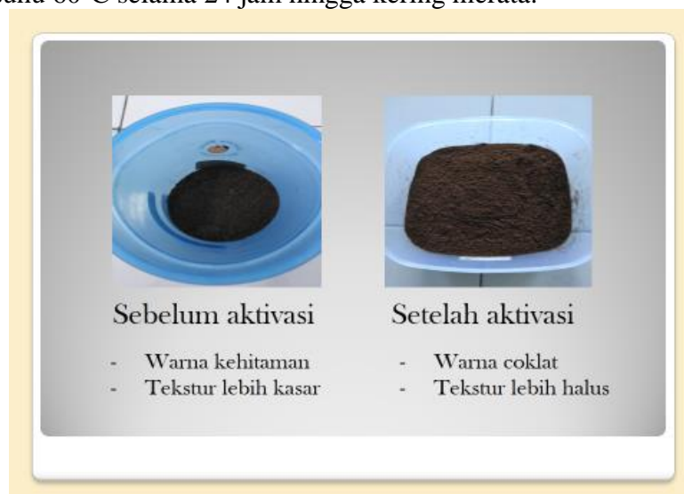
Gambar 2. Perbedaan Adsorben Sebelum Aktivasi dan Setelah Aktivasi dengan Aquadest
