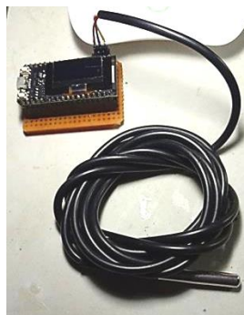
Gambar 2.5. Sensor suhu dipasang pada modul mikrokontroler ESP32 dengan platform microphyton
