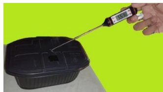
Gambar 2.11. Pencatatan suhu secara manual menggunakan termometer digital
