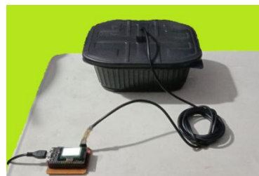
Gambar 2.13. Pencatatan data suhu secara otomatis menggunakan mikrokontroler ESP32
