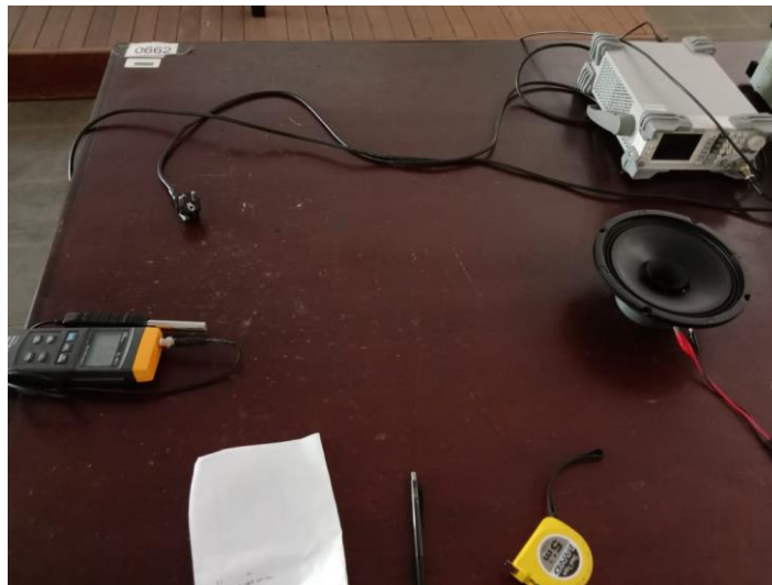
Gambar 3. Pengukuran sinyal sinus dengan posisi cone speaker ke atas
