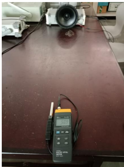
Gambar 4. Pengukuran sinyal sinus dengan posisi cone speaker menghadap SPL Meter
