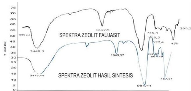
Gambar 2. Spektra Infra Merah Zeolite dari Abu Dasar
