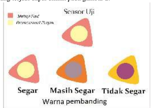
Gambar 2. Perubahan warna pembeding pada Intelligent Packaging (Nurfawaidi, Kuswandi, & Wulandari, 2018).
