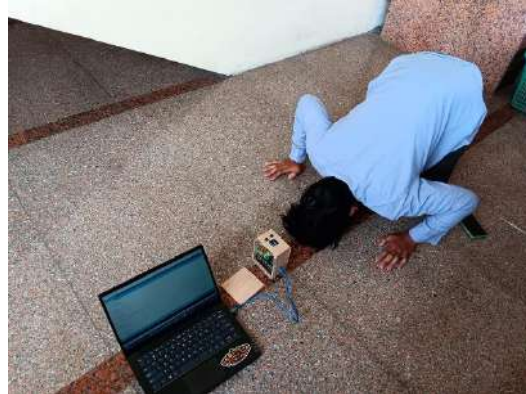
Gambar 8. Pengambilan Data Jarak dan pembacaan Sensor Sharp GP2Y0A21
