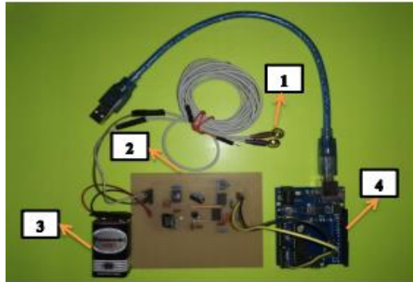
Gambar 5. Komponen Utama Sistem Single Electrode EEG terdiri dari (1) Elektroda, (2) Rangkaian Utama Sistem EEG, (3) Catu Daya dan (4) Arduino Uno
