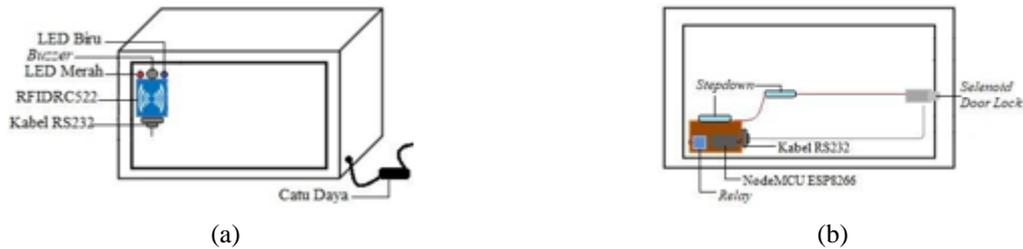
**Gambar 4.** Kerangka miniatur brankas (a) tampak luar (b) tampak dalam
