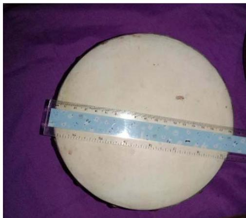
Gambar 3 : Pengukuran diameter pada membran
