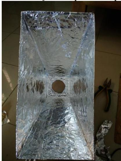
**Gambar 29.** Pelapisan *aluminium foil* (foto: sugito)
