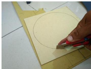
**Gambar 22.** Pemotongan lingkaran ukuran diameter reflektor lampu belajar (foto: sugito)
