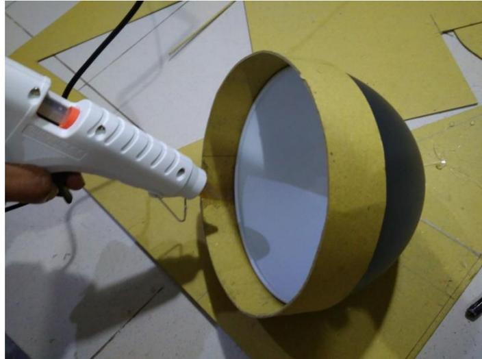
**Gambar 15.** Proses pembuatan lingkaran untuk *honeycomb* (foto: sugito)
